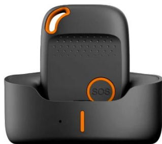
Station d'accueil et de recharge magnétique avec détrompeur
