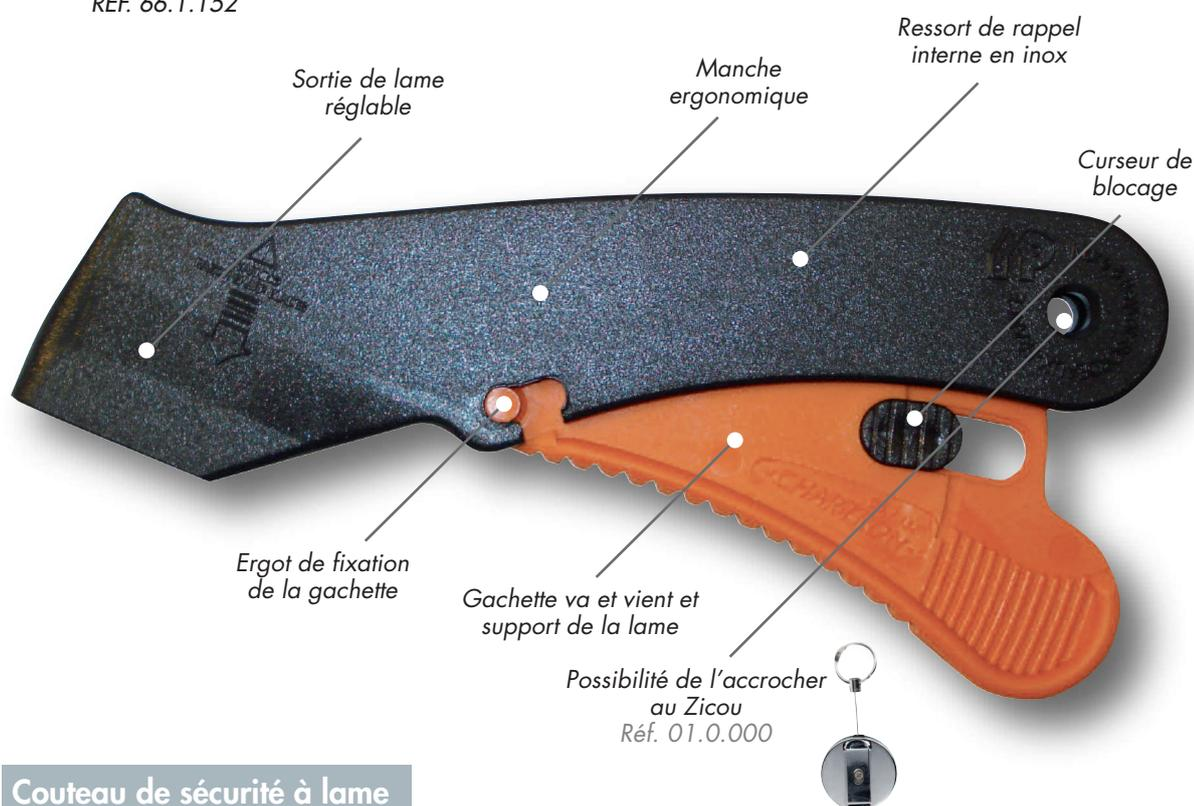
Couteau de sécurité à lame rétractable et blocage possible au repos.
