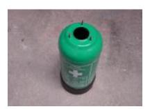
Dévissez les trois écrous de couleur laiton à l'aide d'une clef de 13 et retirez le bloc de mise sous-pression.
