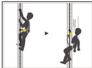
Lors de la progression verticale sur rail ou sur câble, le point d'attache LADDER CLIMB permet de connecter le chariot en position ventrale, ce qui répartit la tension sur la ceinture et assure ainsi un confort optimal. En cas de chute, ce point d'attache remonte automatiquement en position sternale pour assurer une position post-chute verticale du corps.
