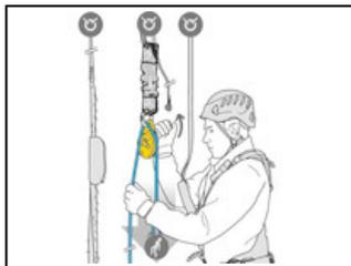
Évacuation grâce au descendeur I'D S, dont la poignée ergonomique permet de contrôler facilement le défilement de la corde lors de l'évacuation.
