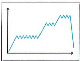
En cas de chute, le déchirement de la sangle de l'absorbeur d'énergie limite la force de choc subie par l'utilisateur. Les longes sont destinées à des utilisateurs dont le poids est compris entre 50 et 130 kg. Le déchirement de la sangle se fait par paliers, afin de limiter la décélération subie par les faibles poids.
