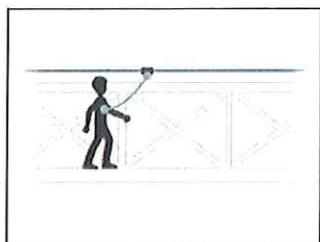
Les longes à simple brin ABSORBICA-I permettent de s'assurer, en particulier sur une ligne de vie horizontale ou sur une plateforme élévatrice, sans passage de fractionnement.
