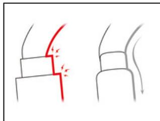
Le design intérieur du mousqueton OMNI limite le risque de point stable et facilite sa rotation.
