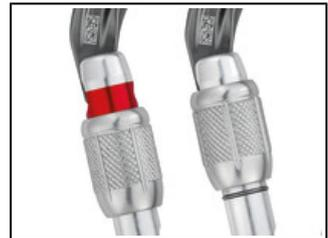
Pour faciliter le contrôle du matériel, les mousquetons à verrouillage manuel SCREW-LOCK possèdent un repère visuel de couleur rouge, visible uniquement lorsque le doigt du mousqueton n'est pas verrouillé.
