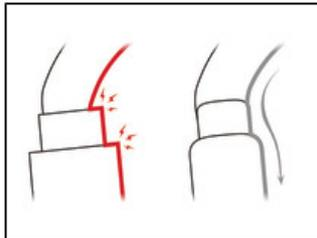
Le design intérieur fluide des mousquetons WILLIAM limite le risque de point stable et facilite la rotation du mousqueton.
