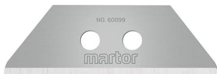
La LAME TRAPÉZOÏDALE N° 60099 de MARTOR est une lame de qualité supérieure en acier. Elle est extrêmement coupante et possède deux côtés tranchants utilisables consécutivement pour une durée de vie prolongée. La lame mesure 55,5 mm de long, 19,0 mm de large et 0,63 mm d'épaisseur. L'Affûtage large facilite la coupe, les pointes arrondies augmentent votre sécurité.
