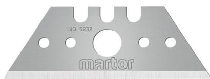
La LAME TRAPÉZOÏDALE N° 5232 de MARTOR est une lame de qualité supérieure en acier. Elle est extrêmement coupante et possède deux côtés tranchants utilisables consécutivement pour une durée de vie prolongée. L'Affûtage large facilite la coupe. La lame mesure 53 mm de long, 19 mm de large et 0,63 mm d'épaisseur.
