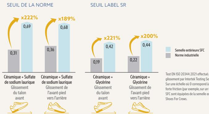
Test EN ISO 20344:2021 effectué pour déterminer la résistance au glissement par Intertek Testing Services Shenzhen Ltd, en août 2022. Sur une échelle où 0 correspond à l'absence de friction et 1 à une très forte friction (par exemple, sur un tapis sec). Toutes les chaussures SFC sont équipées de la semelle extérieure antidérapante brevetée Shoes For Crews.
